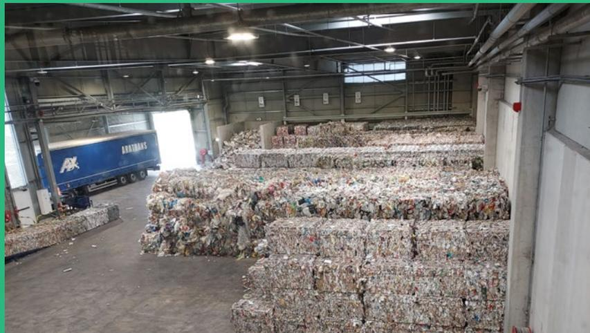
**Le tri s'effectue sur le site situé aux 4 vents à Bourges, 40 salariés y travaillent et chaque jour 30 camions bennes déposent la collecte de 15 collectivités. Le site appartient à TRI - INC et l'exploitant est PAPREC. 30 000 tonnes de capacité de traitement, 140 T jour de collectes traitées et 10 T heure sur la chaîne de tri.**
